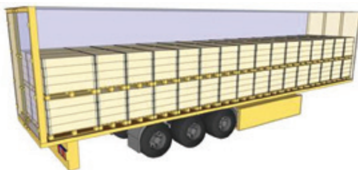
Figur 69: Stuvning af paller i XL-køretøj
