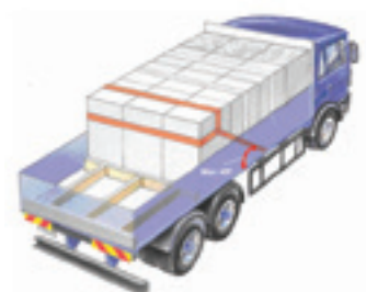
Figur 40: Fjederbelastet surring med sele
