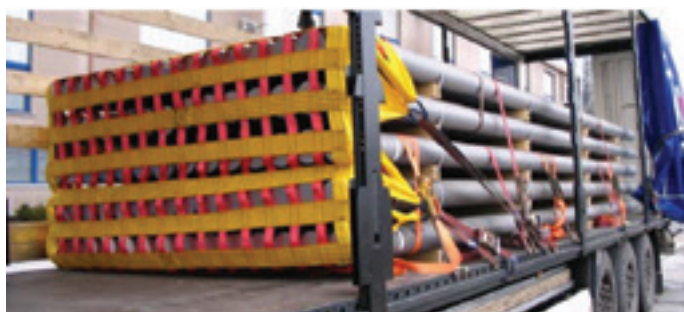
Figur 32: Fastgørelse med net og direkte surring i fremadgående retning
