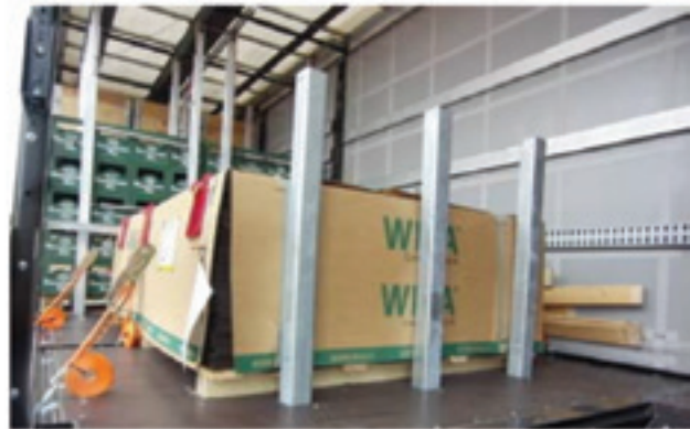
Figur 7: Kæpstokke anvendt til blokering i fremadgående retning
