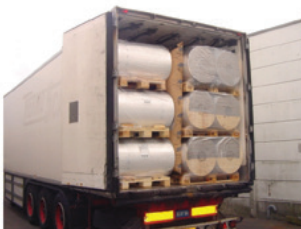
Figur 28 Fyldmateriale mellem rækker af last
