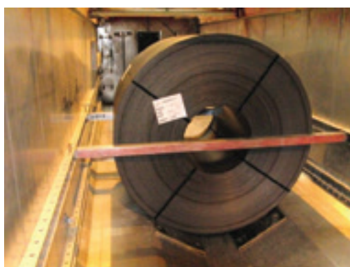
Figur 61: Transport af spole i specialkøretøj
