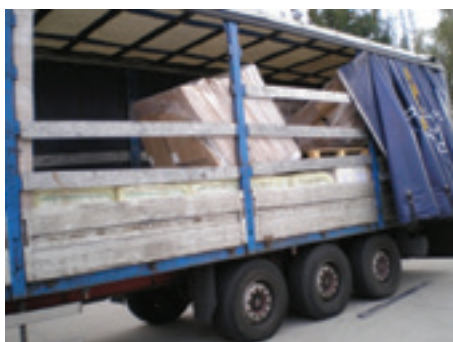
Figur 19: Utilstrækkelig fastgørelse af last udelukkende med strækfilm
