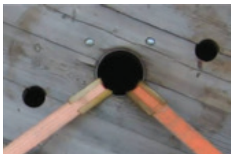
Figur 22: Beskyttelse mod skarpe kanter
