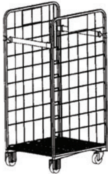
Figur 70: Hjulpalle med sidestøtte og stænger
