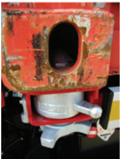
Figur 17: Drejelås med container
